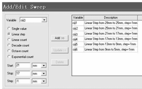
图 5 对次级线圈尺寸进行参数化扫描
