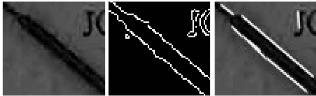
(a) 指针图像 (b) 指针边缘图 (c) Hough 直线检测
