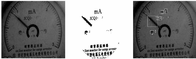
(a) 方形表盘识别区 (b) 预处理后区域屏蔽图 (c) 筛选后连通区域图 图 3 指针粗定位
