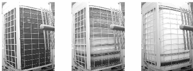
图 1 结化霜过程霜变化示例图
