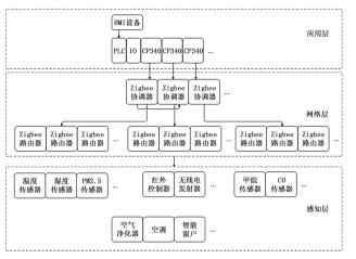
图 1 系统总体网络结构图
