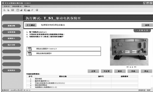
图 3 交互式智能诊断系统 (IIDS) 故障推理界面
