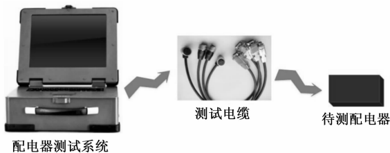
图 8 配电器测试系统测试示意图
