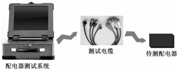
图 8 配电器测试系统测试示意图
