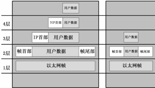
图 1 PROFINET 对标准 TCP/IP 协议的优化
