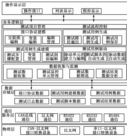
图 3 舰船装备软件测试系统软件体系结构
