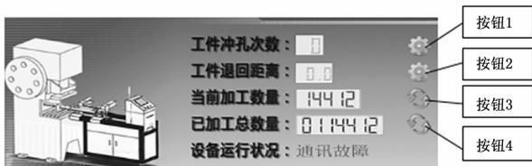
按钮 1: 工件冲孔次数的设置 按钮 2: 退回距离的标定
