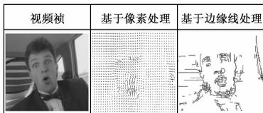
图 3 视频图像运动的光流场计算处理结果
