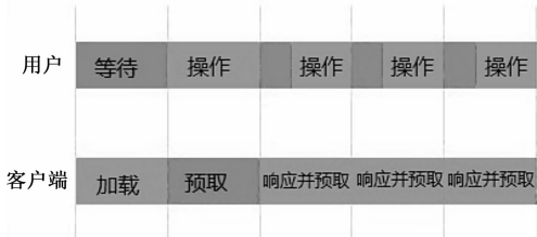
图 4 预取机制下工作模式示意甘特图
