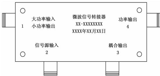
图 2 微波信号转接器示意图
