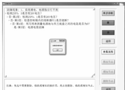
图 4 单步诊断流程
