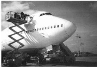
图 7 波音 747 红外热波检测现场照片
