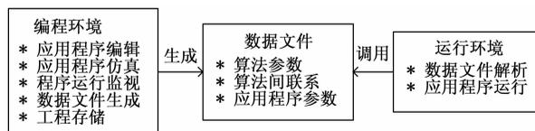
图 1 系统结构组成
