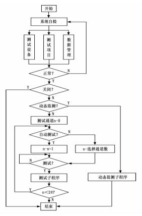
图 3 测试主程序流程图
