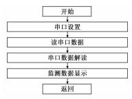
图 5 动态监测子程序流程图
