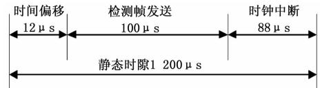
图 7 静态时隙 1 结构
