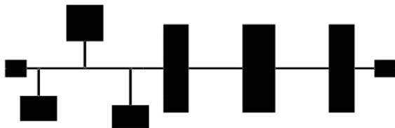
图 5 级联结构滤波器版图
