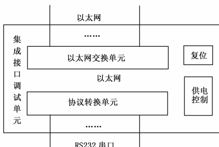
图 2 集成接口调试单元的硬件结构
