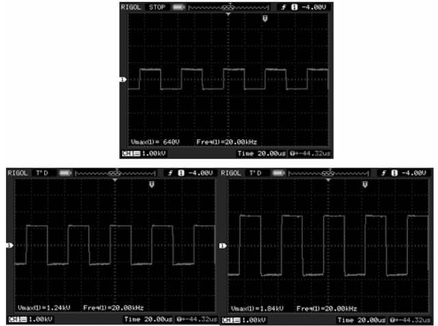
图 6 高频方波脉冲输出波形
