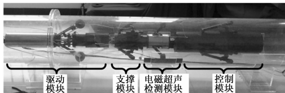
图 1 管道机器人系统组成示意图模块
