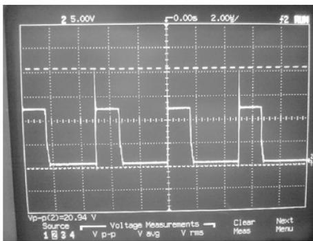
图 4 本文系统采集的机载测量数据 ARINC429 波形图
