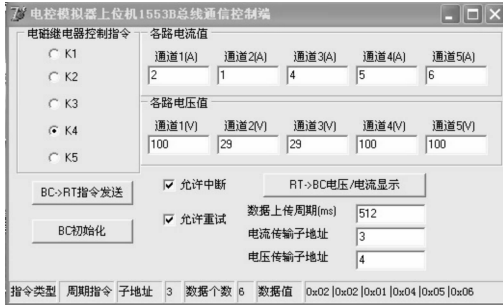
图 4 电控模拟器上位机 1553B 总线通信控制界面
