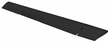
图 1 机翼整体有限元模型
