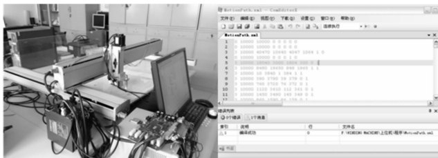
图 6 直角坐标机器人和 HPGL 程序编译器
