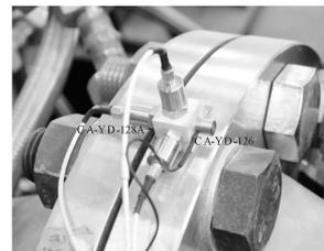
图 2 测振块和加速度计的安装位置
