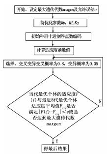
图 3 遗传算法优化流程图
