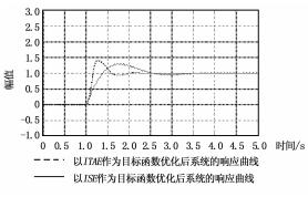
图 2 分别以 ITAE 与 ISE 作为目标函数优化后的系统响应曲线对比
