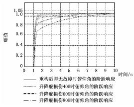
图 4 升降舵损伤 40%,60%,80%及重构后即无故障时 俯仰角的阶跃响应过渡曲线
