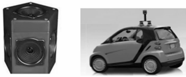
图 3 Ladybug3 及其在汽车导航的应用
