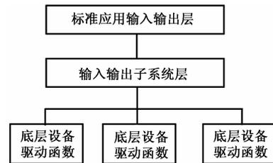
图 1 MQX 设备驱动三层管理结构
