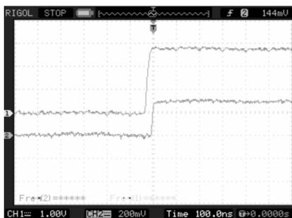
图 5 输出秒脉冲与 GPS 时标的相位比较
