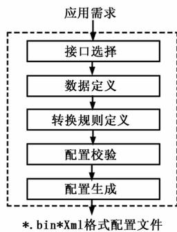
图 5 远程数据采集器配置流程
